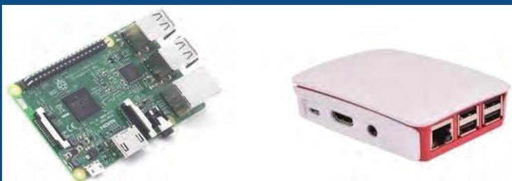
Figure 1 : Raspberry Pi 3 modèle B (carte mère et interfaces à gauche, boîtier à droite)
